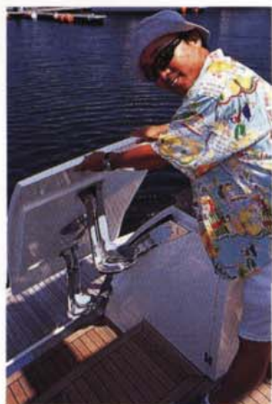
凝りに凝ったトランサムドア。ダブルリンクで開閉するが、重いのでこれは電動が油圧にアップデートしたいところだ。
