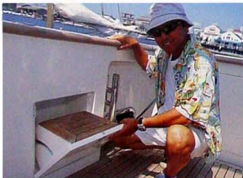
スターンコックピットのcabには収納式のステップが、これは必要にして邪魔な存在のステップのうまい処理方法だね。
