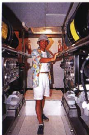
国内初登場のキャタピラーC30。エンジンの周りにはグラブレールの配慮もあり、室内は立って歩け、メンテナンス性も上々。
