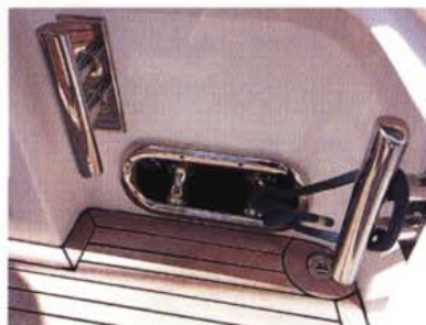
スターンのクリートとロープホール。低い位置にレイアウト。外から見るとちょうどブラックストライプの中に位置する。
