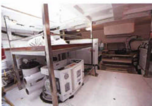
右舷側には造水器、ジェネレーターなどが装備されている。その上段は荷物をかけるように棚がもうけられている。
