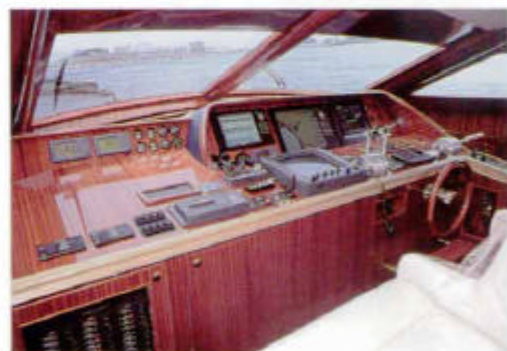
こちらは左舷側からの絵。すべてがダブル装備されているので計器類の数は多い。
