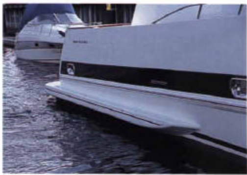
本船の特徴ともいえるフローティングデバイス。低速航行時の安定性に寄与するのだとか。
