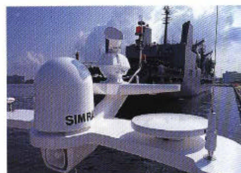
左側のドームがCSテレビのアンテナ。一部の機器はシムラッド社以外のものが搭載されている。
