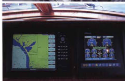
日本初見となるCAT C30。1基25トンもの重量がある。ヘルムステーションにはオプションのエンジンビジョンディスプレイシステムがマウントされており、タッチスクリーンには思いつづくものはすべてのエンジンデータが表示される。このデータ類は他の計器類ともシェアされる。
