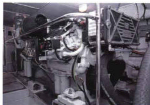
日本初見となるCAT C30。1基25トンもの重量がある。ヘルムステーションにはオプションのエンジンビジョンディスプレイシステムがマウントされており、タッチスクリーンには思いつづくものはすべてのエンジンデータが表示される。このデータ類は他の計器類ともシェアされる。
