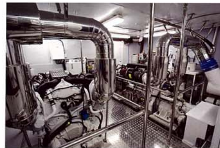
まさに機室室という言葉に相応しい広大なエンジンルーム。その回り込みは細部まで妥協を許さない。搭載されるエンジンは環境性能にも優れたCAT C32 ACERT 1,825馬力×2基。
