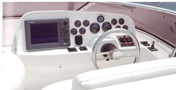
フライブリッジのヘルムコンソールには視認性の良いアナログのゲージ類や航海計器、各種スイッチ類が並ぶ。コンソール自体のデザインにはもう少し色気が欲しいところだ。
